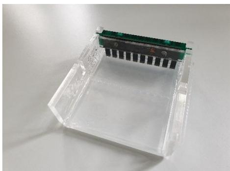
Abb. 3: Gießrahmen mit ausgehärtetem Gel. Einer der beiden Käbme steckt noch im Gel.
